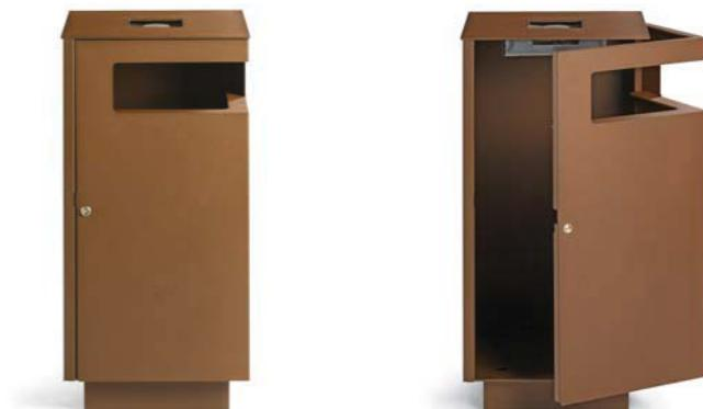
Corbeille carrée autoportante. Le corps avec la porte avant renforcée est en tôle d'acier et est équipé d'une serrure à clé triangulaire et d'une fente appropriée pour l'insertion des déchets.
